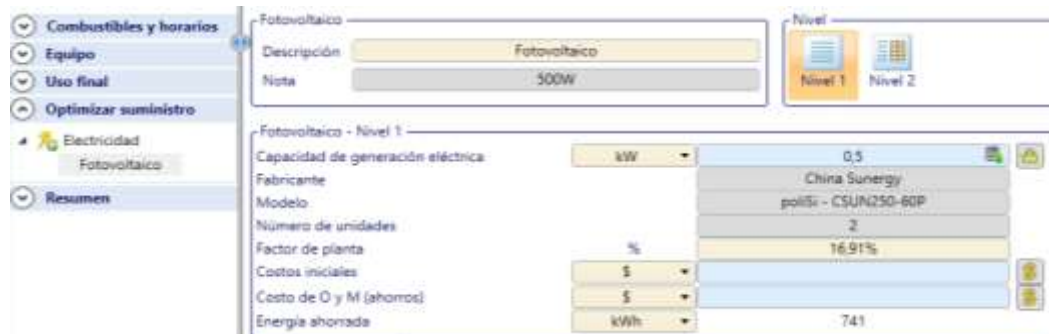
Figura 34: Modelo en RETScreen para un sistema fotovoltaico de 500W.
