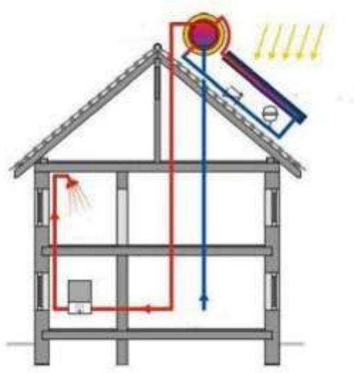
Figura 11: Energía Solar Térmica (Agua Caliente Sanitaria).
