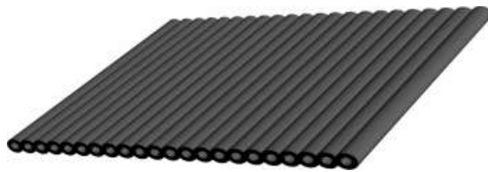
Figura 15: Ejemplo de colector simple sin cubierta.
