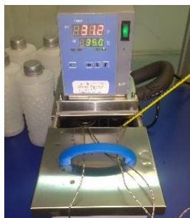
Ilustración 16. Calibración de sensores en baño termostático
