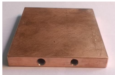
Ilustración 14. Placa de cobre con orificios para resistencias.
