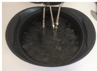
Ilustración 17. Calibración de sensores en hielo.
