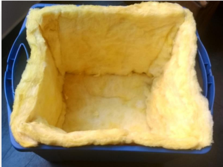
Ilustración 18. Caja plástica cubierta en su interior con lana de vidrio.
