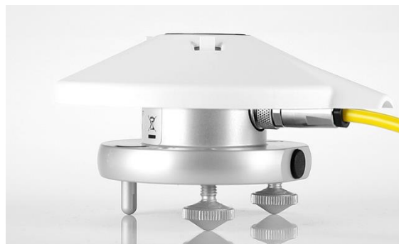
Ilustración 3. Pirgeómetro Kip & Zonen CGR3. [9]
