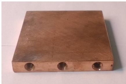
Ilustración 13. Placa de cobre con orificios para sensores de temperatura.
