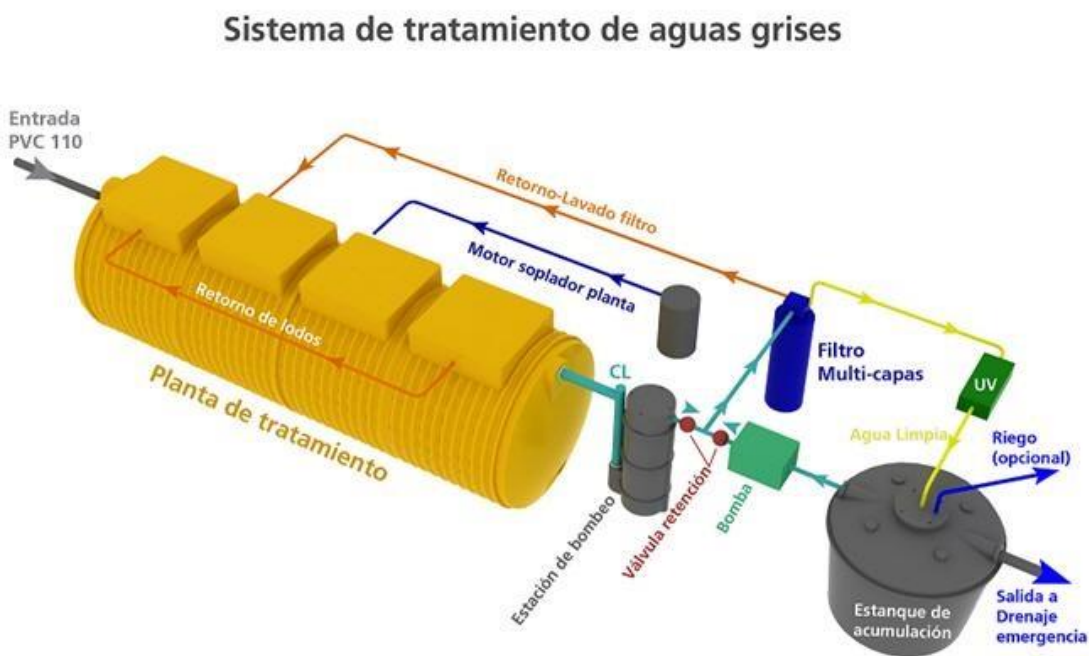
Figura 3.5 Sistema de tratamiento de aguas grises.
