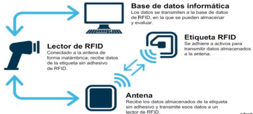
Figura 3 - Sistema básico RFID. https://www.almagrario.com/tecnologia-rfid
