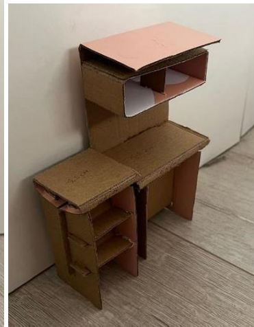
Imagen 33 -Prototipo a escala 1:10 estación de trabajo para picking.
