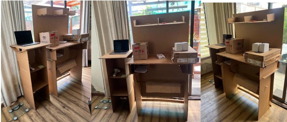
Imagen 35 -Prototipo a escala real de estación de trabajo para picking.
