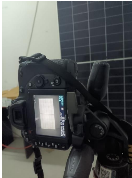
Figura 10 Montaje de EL
