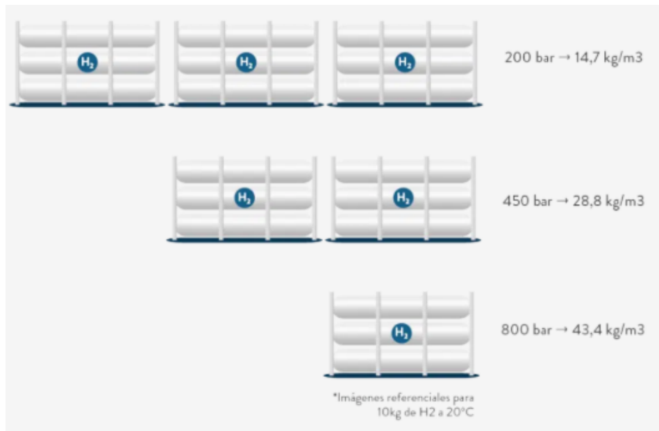
Figura 2: Comparación del volumen ocupado almacenado a distintas presiones [9].
