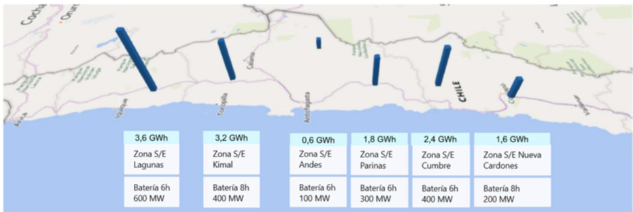
Figura 3.13: Distribución de sistemas de almacenamiento en red simplificada al año 2026. Elaborada por el CEN. [6].
