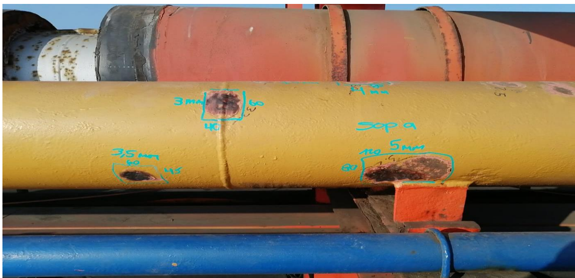
Figura 1.5 Corrosión general en elementos soldados a cuerpo de cañería uniones de tubos y soportes de cañería.
