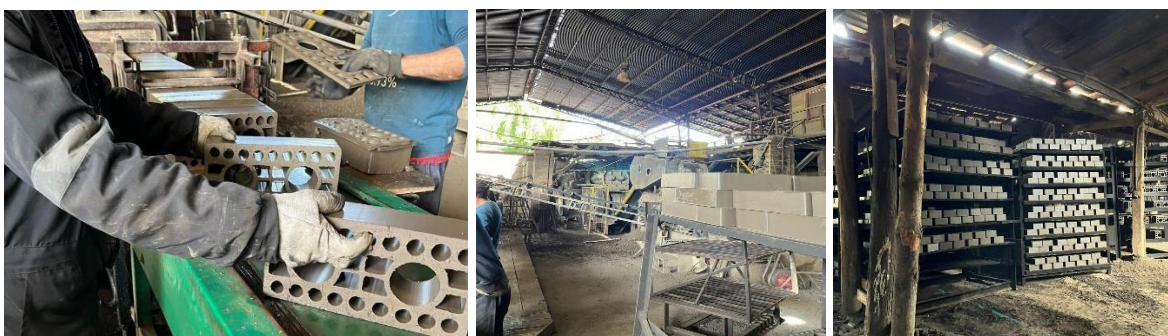
Imagen N°13, 14 y 15: Registro fotográfico etapa moldeo y corte de ladrillos.
