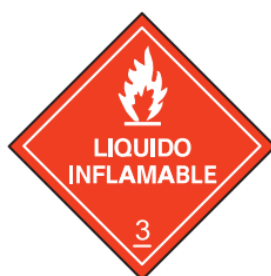
Figura 139: Etiquetado según nCh 2190 para líquidos inflamables almacenados en el taller metalmecánico.
