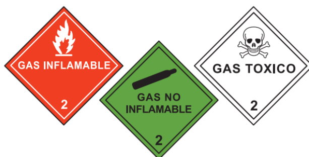
Figura 66: Etiquetado según nCh 2190 para gases almacenados en el taller metalmecánico.
