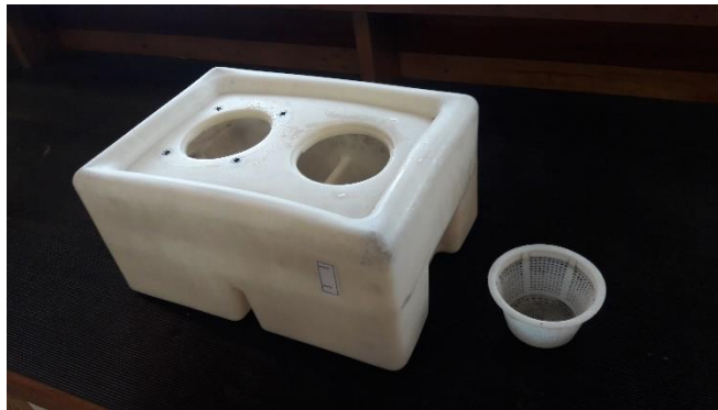
Figura 119: Filtro de lubricación de la rectificadora ubicada en el taller.
