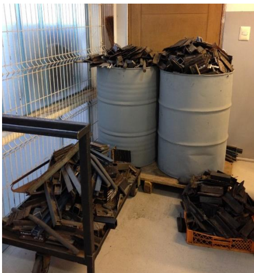
Figura 27: Almacenamiento de la Chatarra almacenada durante dos semestres académicos en el taller metalmecánico.
