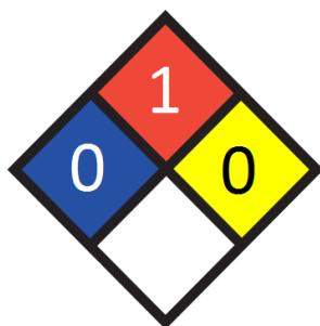
Figura 137: Etiquetado de área de almacenamiento de líquidos inflamables según NCh 1411.
