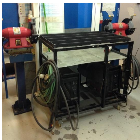
Figura 34: Ejemplo de reutilización de estructuras metálicas para contenedor de equipos de Soldadura.
