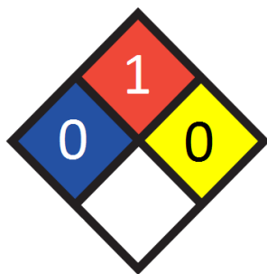
Figura 65: Etiquetado de área de almacenamiento de líquidos inflamables según NCh 1411.
