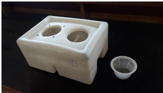
Figura 58: Filtro de lubricación de la rectificadora ubicada en el taller.
