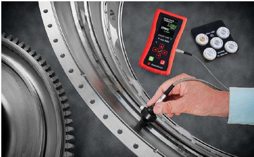
Ilustración 2.14 Ensayo de Corrientes de Eddy en componentes aeronáuticos.
