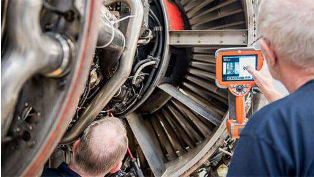
Ilustración 2.15 Inspección boroscópica en las etapas de turbina de un motor aeronáutico.
