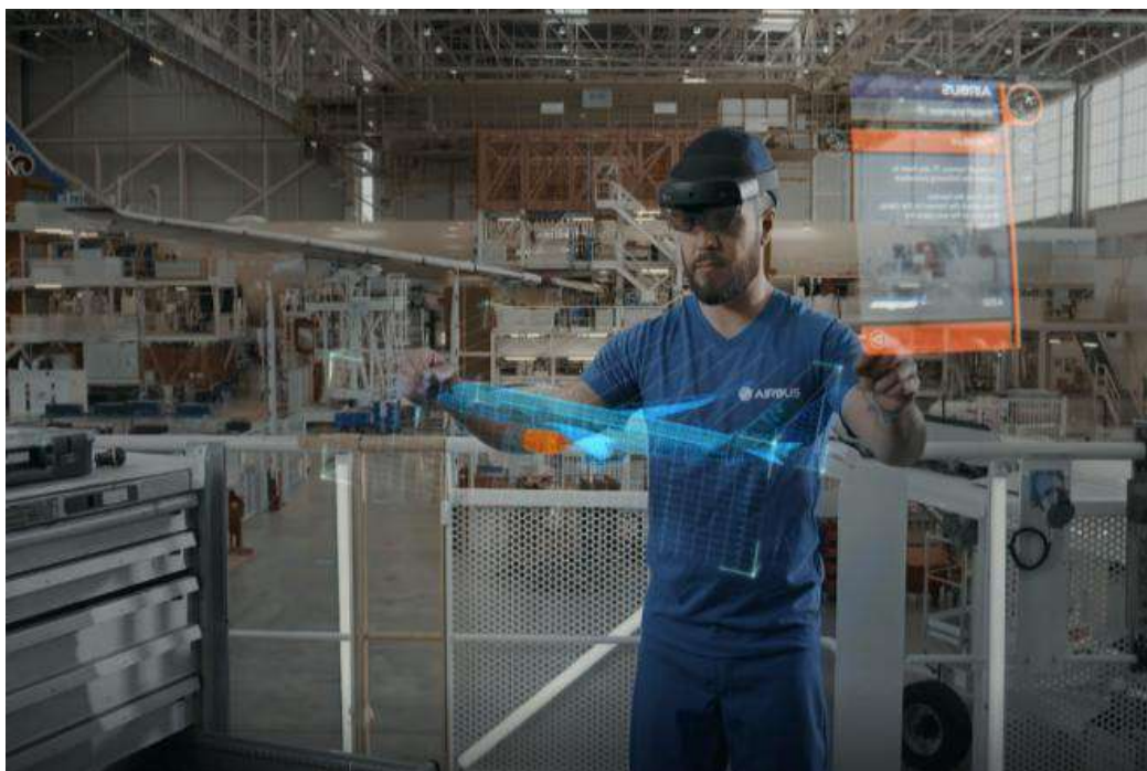
Ilustración 2.3 Uso de tecnología de Realidad Aumentada/Mixta en el mantenimiento aeronáutico.
