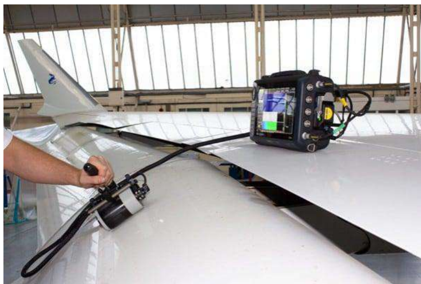
Ilustración 2.13 Inspección estructural mediante ultrasonido de arreglo de fases (PAUT).
