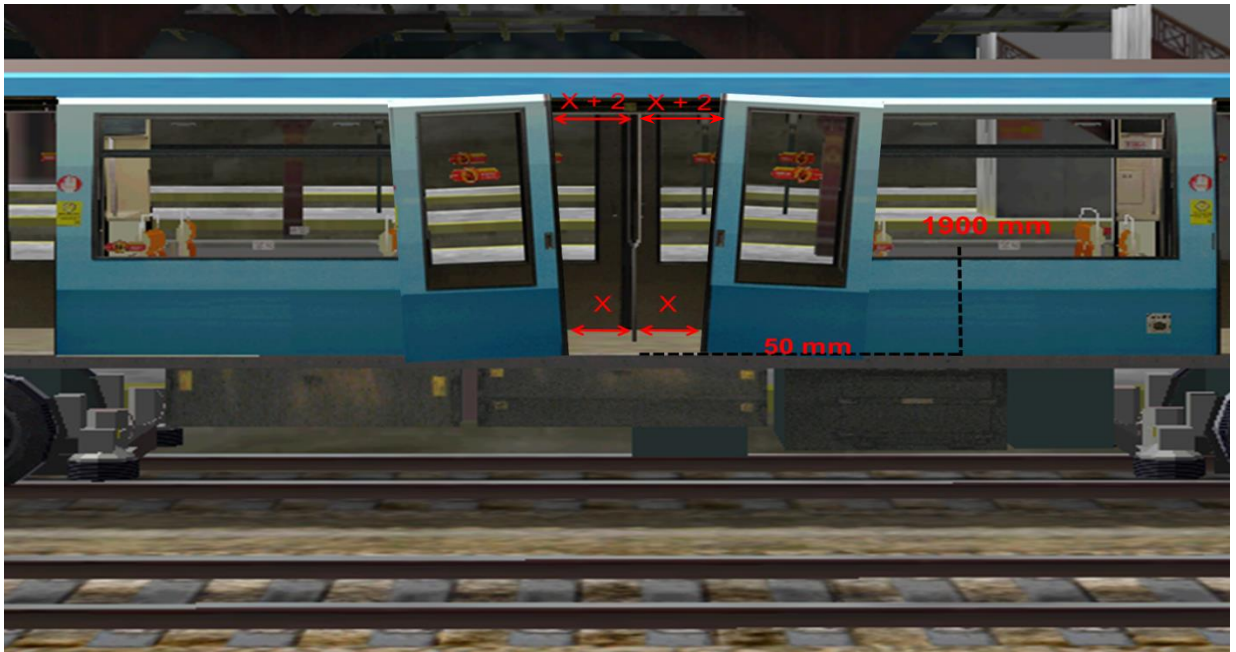
Figura 7. Paralelismo de las hojas de una puerta del tren NS93. (Fuente: Metro de Santiago).
