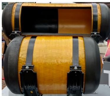
Figura 7: Contenedor de hidrógeno gaseoso utilizado en el vehículo Toyota Mirai, correspondiente a cilindro tipo IV.
