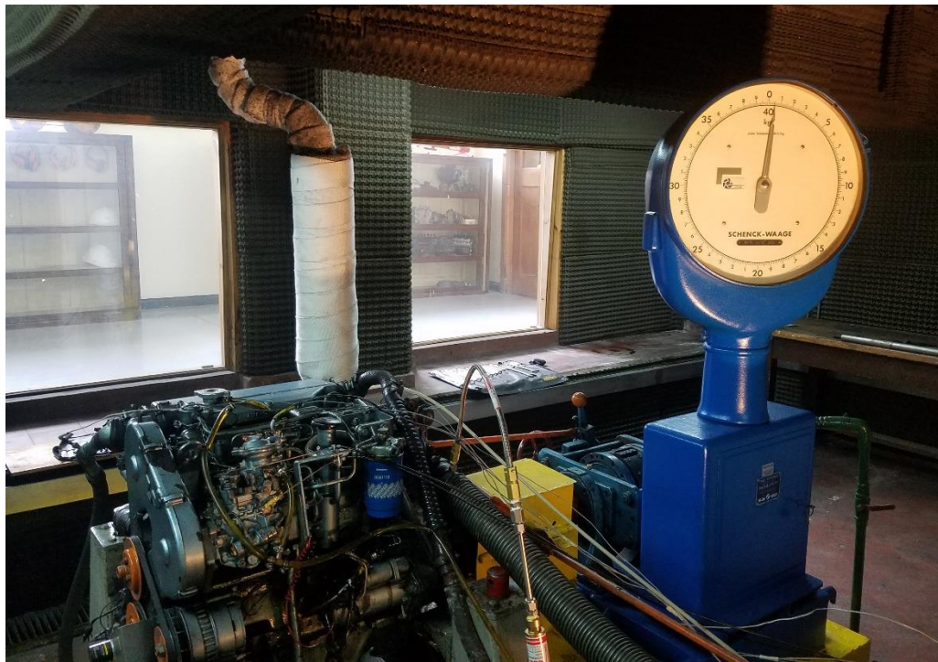
Imagen 3.1: Vista general del conjunto freno-motor.
