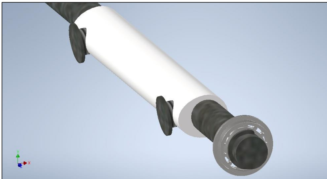
Figura 13-27: Propuesta final de unión eje-polea.
