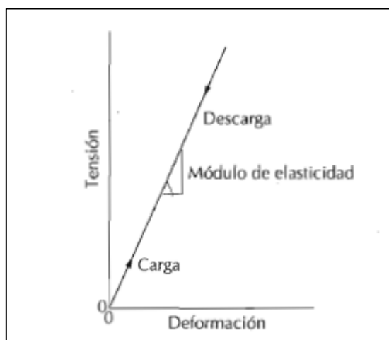
Figura 6-12: Diagrama de tensión en función de la deformación con deformación elástica [34].
