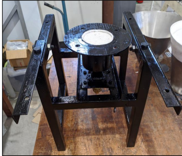
Imagen 31: Estructura de soporte reactor.
