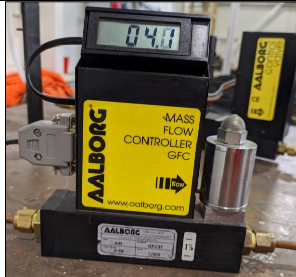
Imagen 27: Controlador de flujo másico para el GLP.
