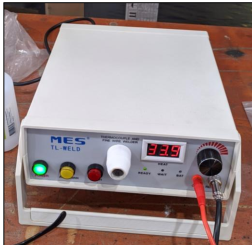
Imagen 29: Fusionadora de Termocupla encendida.
