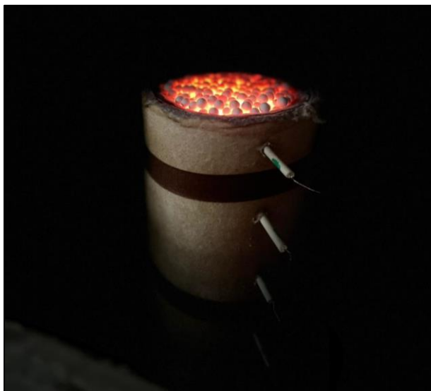
Imagen 35: Reactor cilíndrico encendido.
