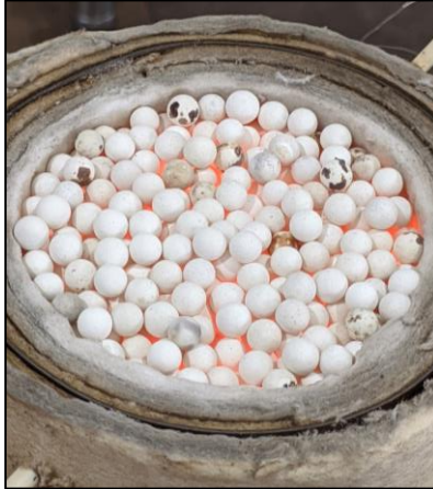
Imagen 21: Esferas de alúmina de 5,6 [mm] de diámetro de un reactor encendido.
