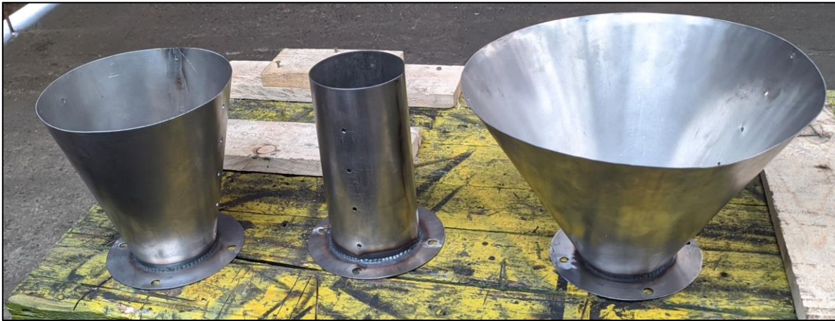
Imagen 30: Estructuras fabricadas de los reactores.
