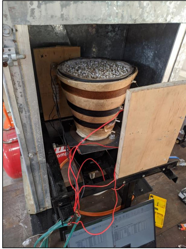
Imagen 36: Reactor cónico de 15° en pruebas y adquisición de datos.
