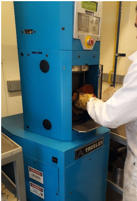
Figura 3-10: Introduce el molde con la mezcla para la compactación.
