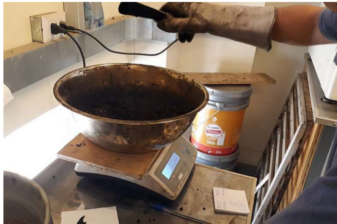
Figura 3-6: Incorporación del asfalto al recipiente.
