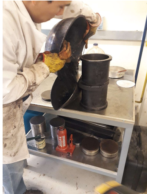
Figura 3-7: Con la ayuda de una "puruña", se introduce la mezcla en el molde.
