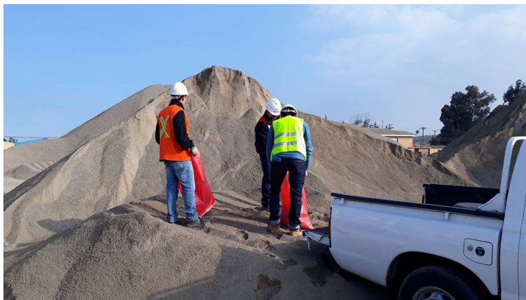
Figura 3-2: Extracción de los áridos desde la Planta Asfalcura.
