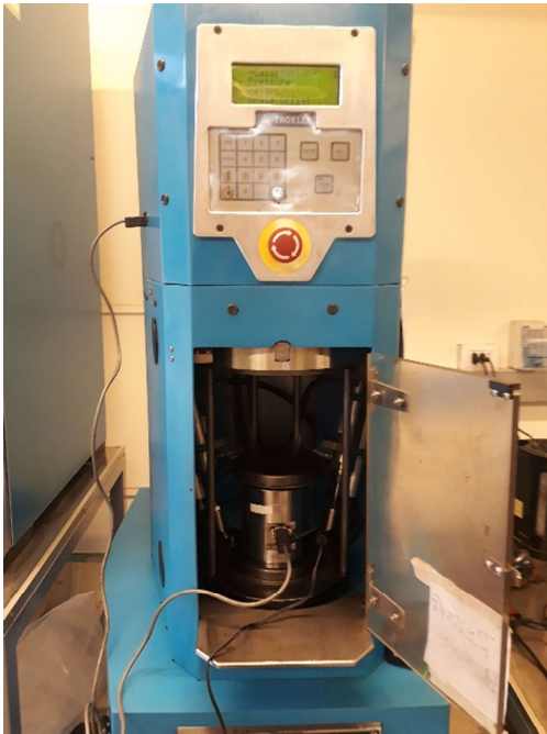
Figura 3-8: Calibración por presión del Compactador
