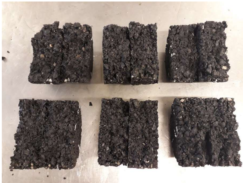
Figura 3-14: Probetas después del ensayo TSR.
