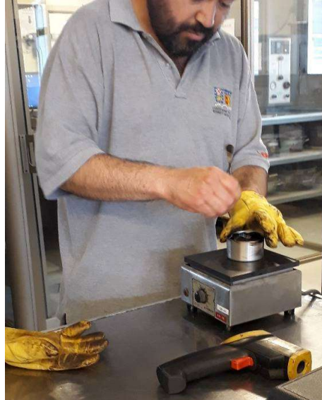
Figura 3-1: Proceso de mezclado de los dos ligantes.
