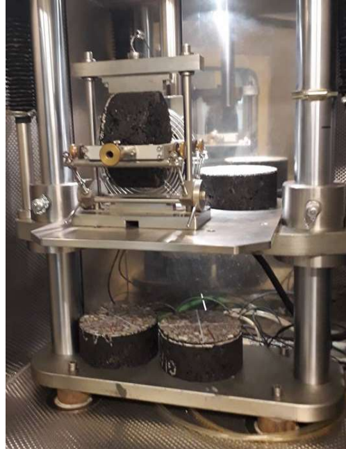
Figura 4-3: Probeta en el dispositivo y dentro del equipo, Ensayo Rigidez.
