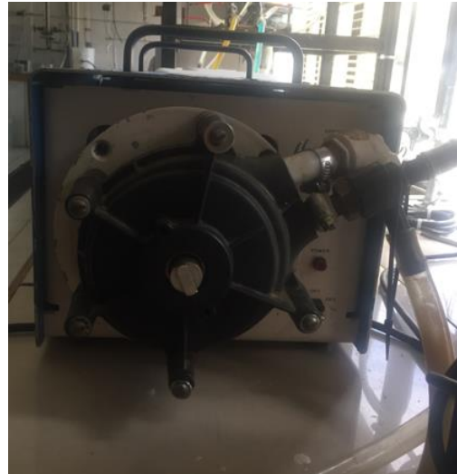
Figura A-2: Bomba Peristáltica 2.
