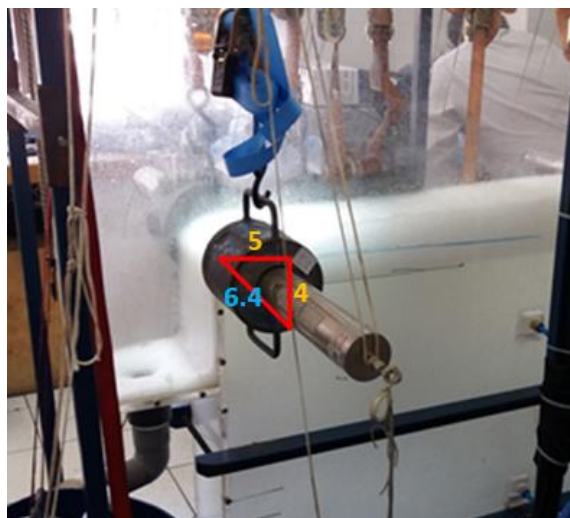
Figura 4.24: Distancia desde punto de inyección a rebalse.
