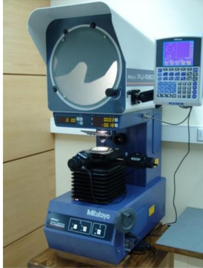
Figura 32: Proyector de perfiles. Laboratorio de Mediciones, UTFSM.
