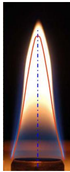
Figura 2.13: Llama representativa generada por el quemador Inverso
