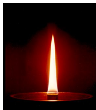
Figura 2.9: Llama típica generada por un quemador tipo Gülder.
