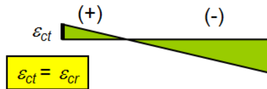
Figura 53.- Diagrama de deformación unitaria - Agrietamiento del hormigón
