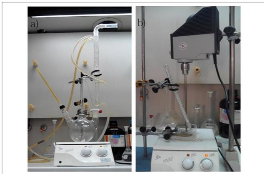
Montaje del equipo para la síntesis del polímero. a) Relación 1:2. b) Relación 1:1
