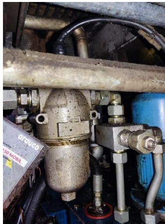
Figura 16: Filtro de presión con filtración en unidad Hidráulica (Fuente: Fotografía propia)
