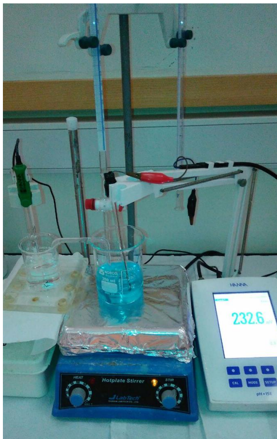
Figura 8. Equipo de determinación potenciométrica de cloruros.
