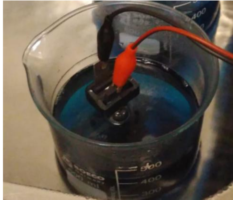
Figura 16. Experimento A.5.1.1. Burbuja entre la superficie del electrolito y el ánodo de grafito.
