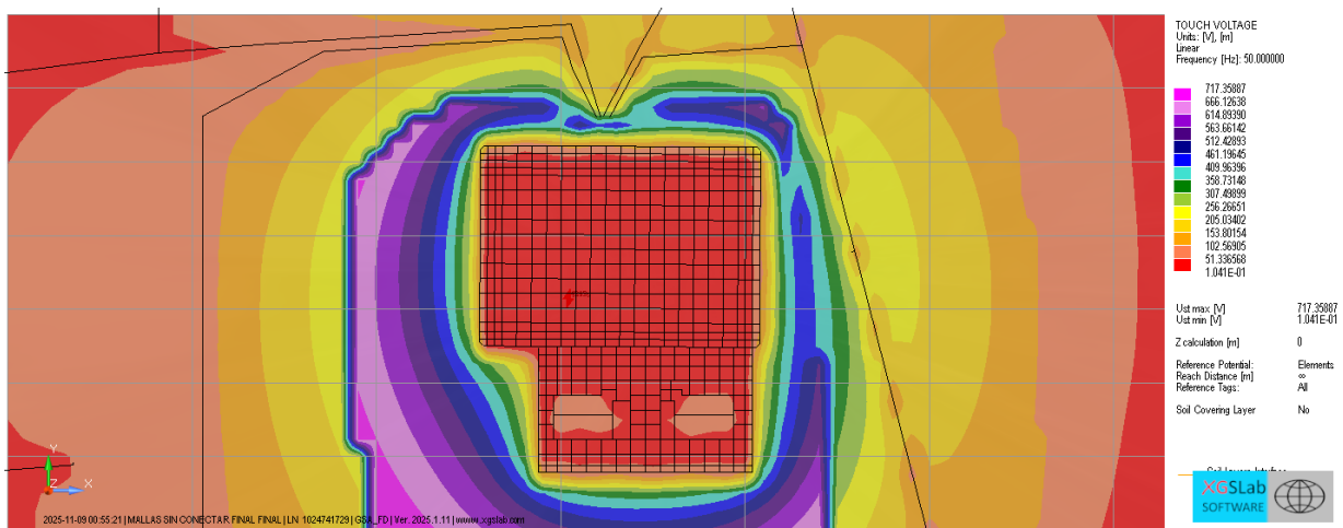
Figura 5.29: Distribución de la tensión de contacto para la configuración (a), Caso III.
