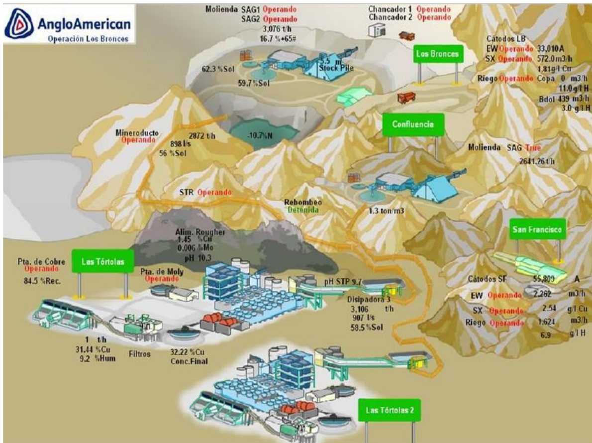
Figura 1: Diagrama de Procesos General de la faena Los Bronces.
