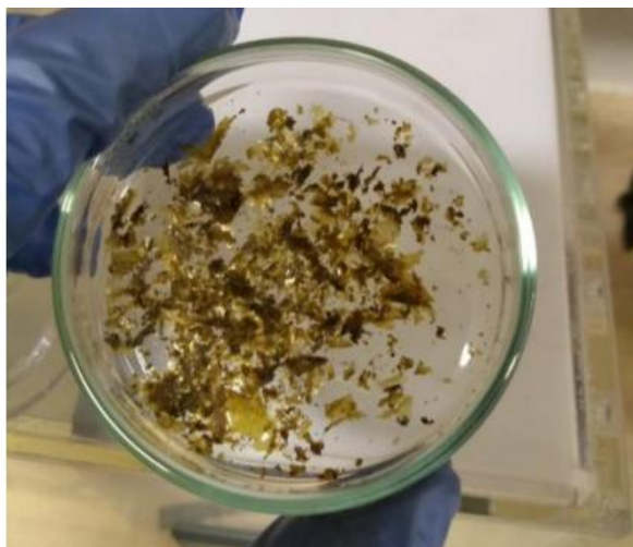
Figura 4.5. Lignina en “escamas”, obtenida luego de evaporación por ventana refractiva. Elaboración propia.
