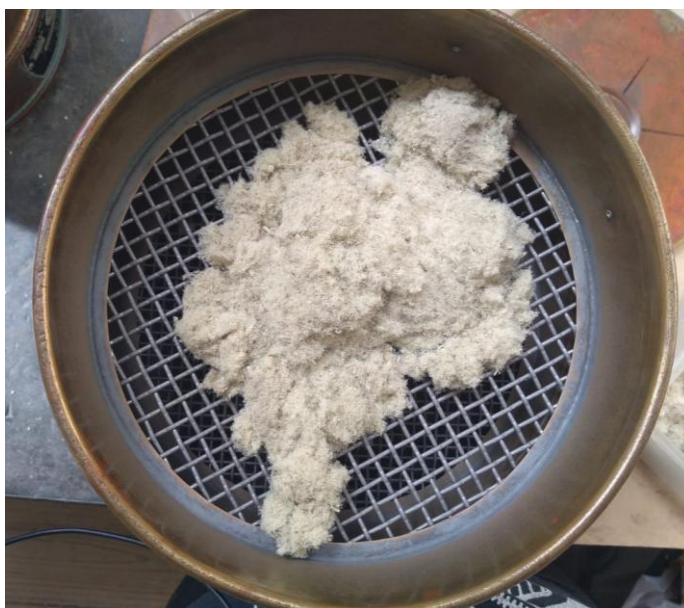
Figura 5.2. Fibras de celulosa retenidas por la malla superior en el proceso de tamizado. Elaboración propia.
