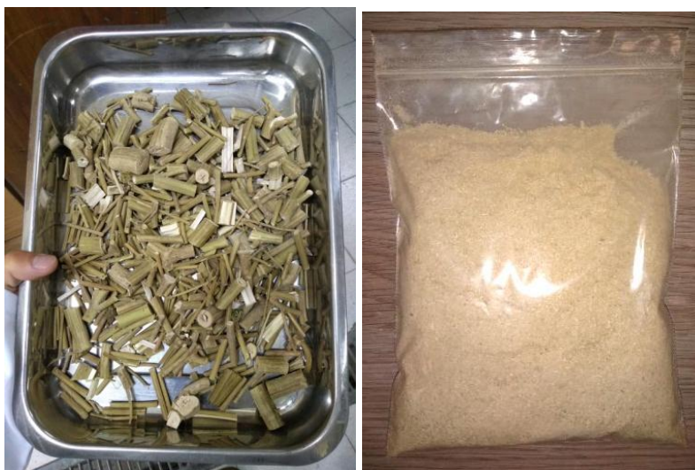
Figura 4.1. A la izquierda, tallos de Cannabis cortados en trozos de largo aproximado de 3-5 [cm]. A la derecha, aserrín fino de madera de tallo de Cannabis con tamaños menores a 1 [mm]. Elaboración propia.
