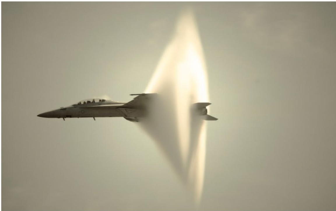
Imagen 1: Onda de choque oblicua producida sobre una aeronave militar.
