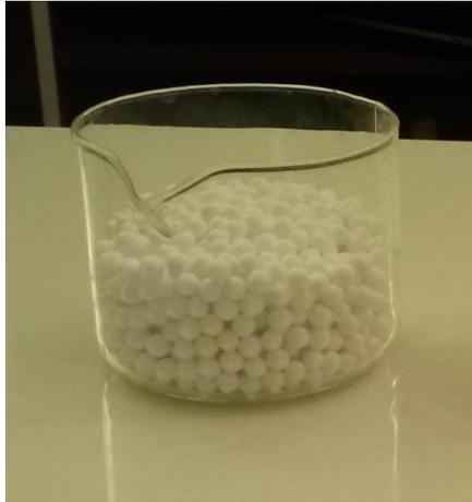
Figura 4.1: Esferas de Alúmina Utilizadas como Medio Poroso.
