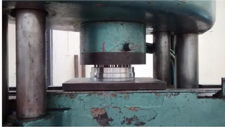
Figura 4.10: Prensa Hidráulica Comprimiendo el Catalizador.
