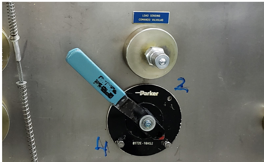
Figura 3.4: Palanca de válvula selectora (componente n°52).
