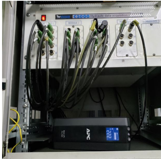
Figura 3.9: Data Logger utilizado para la medición de parámetros (componente n°70).
