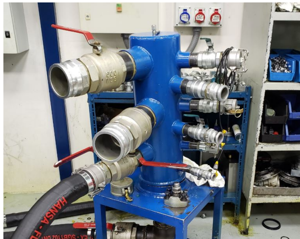
Figura 3.10: Manifold de alimentación (componente n°71).
