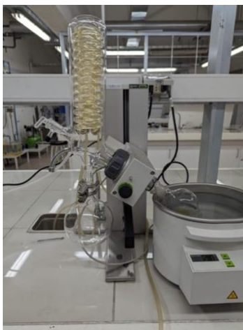
Figura 14: Sistema de rotaevaporación del Laboratorio de Mecánica de Fluidos del campus San Joaquín.
