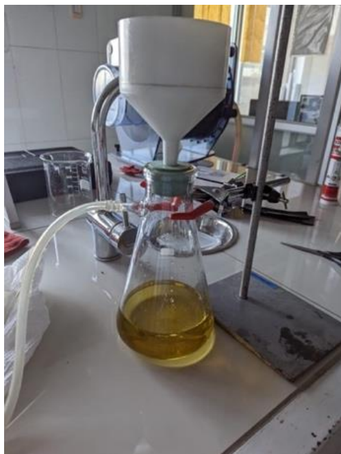
Figura 12: Sistema de filtración al vacío compuesto por un soporte universal, pinza tres dedos, matraz Kitasato, embudo Büchner y la manguera que está conectada a la bomba de vacío.
