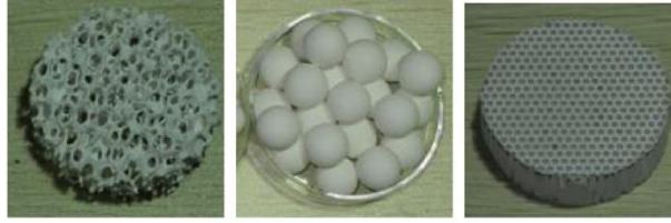
Figura 1.7. Imágenes de diferentes estructuras de medios porosos. De izquierda a derecha: Espumas reticuladas, perlas, monolitos de panal. Tomado de [9].
