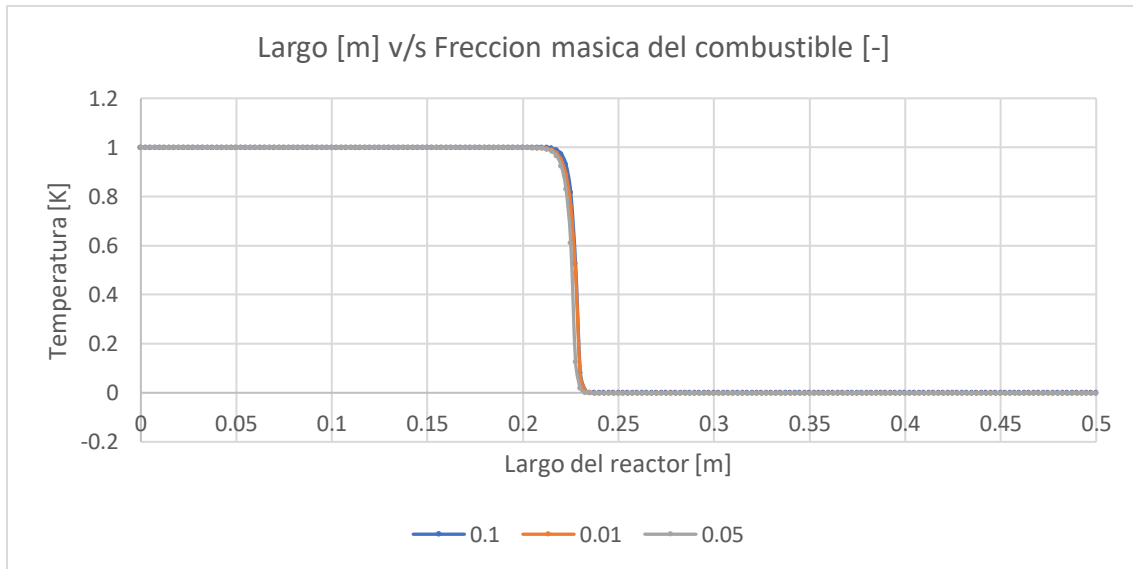
Figura 4.6. Fracción másica del combustible en el eje de simetría para un paso de tiempo \Delta t = 0.10 [s], \Delta t = 0.05 [s] y \Delta t = 0.01 [s]
