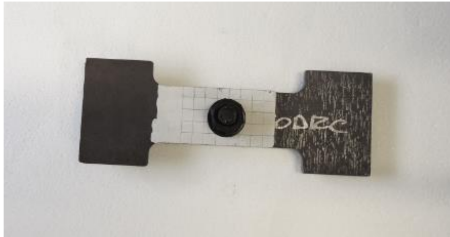
Figura 1-1 Probeta compuesta por dos placas y un perno central
