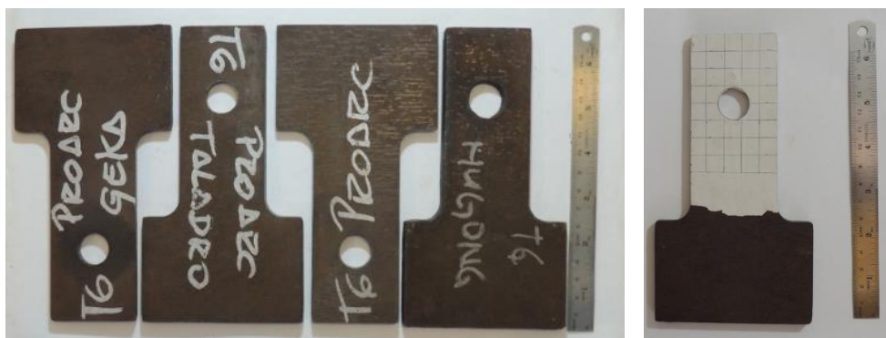
Figura 4-7 Medición y contabilización de placas (izquierda); pintura y cuadriculado (derecha)
