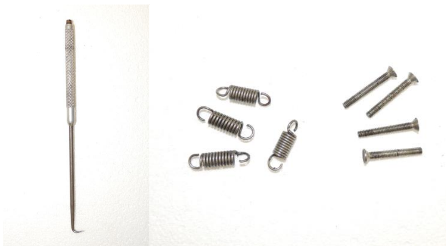
Figura 4-4 Herramienta de ajuste, resortes y tornillos para instalar las mordazas
