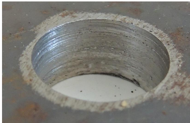
Figura 3-8 Acabado superficial de perforación realizada con taladro
