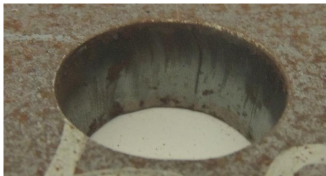
Figura 3-2 Acabado superficial de agujero realizado con plasma de alta definición
