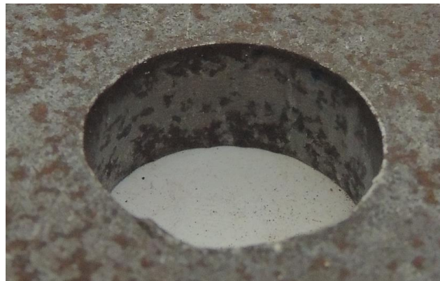
Figura 3-4 Acabado superficial de agujero realizado con plasma de definición estándar
