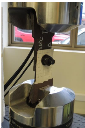
Figura 4-9 Montaje de probeta directo a máquina MTS 810
