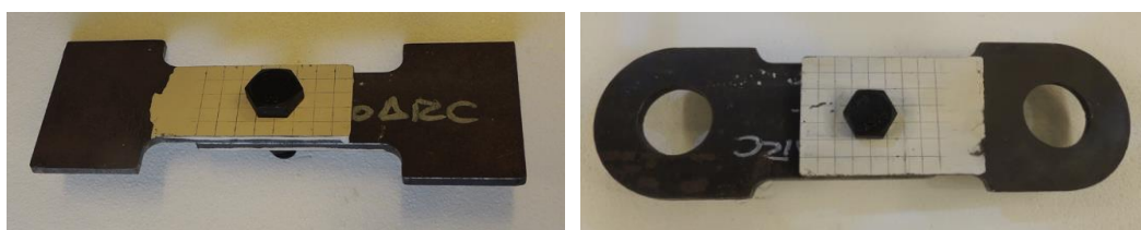
Figura 4-8 Unión de placas mediante un perno
