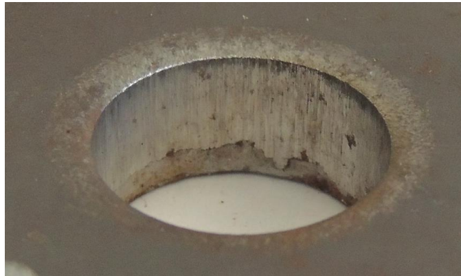
Figura 3-6 Acabado superficial de perforación realizada con punzonado
