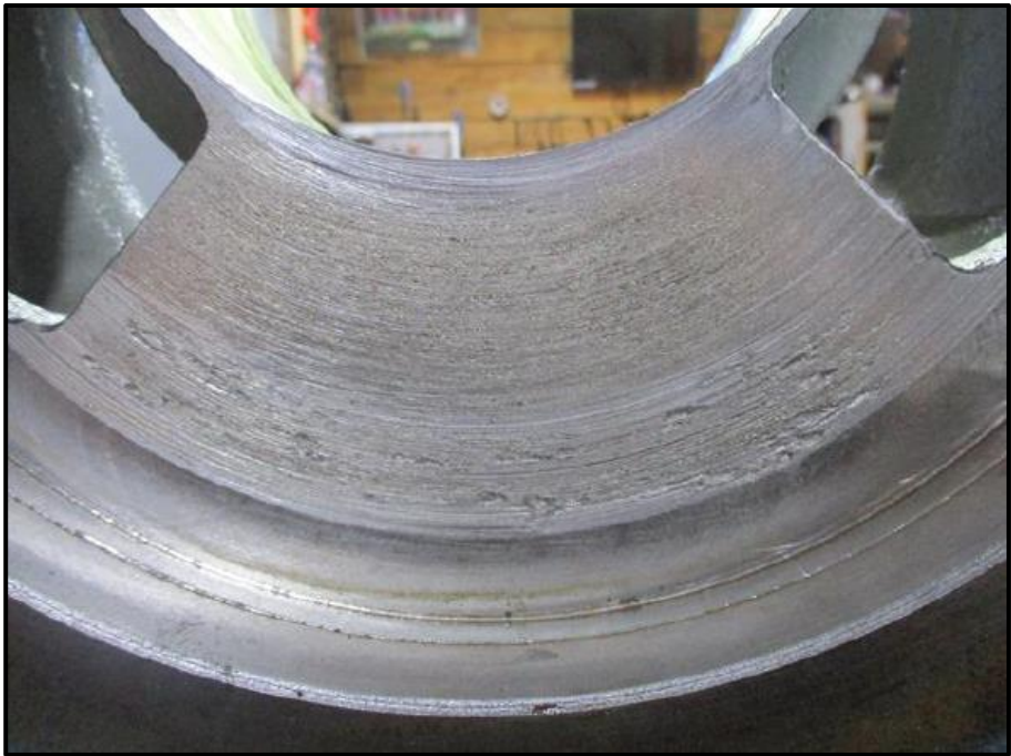
Figura 3-5. Desgaste en carcasa de bomba.
