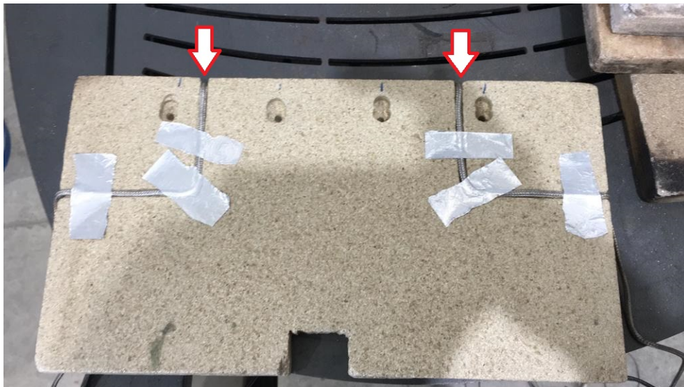
Figura 17: Intervención de vermiculita mediante canales y perforaciones, las flechas indica el lugar donde se perfora y posiciona la termocupla dentro de la vermiculita
