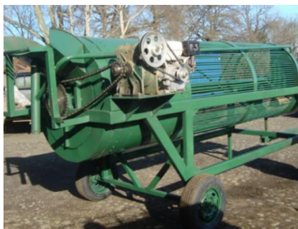
Figura 2-7. Registro fotográfico lavadora de zanahorias.
