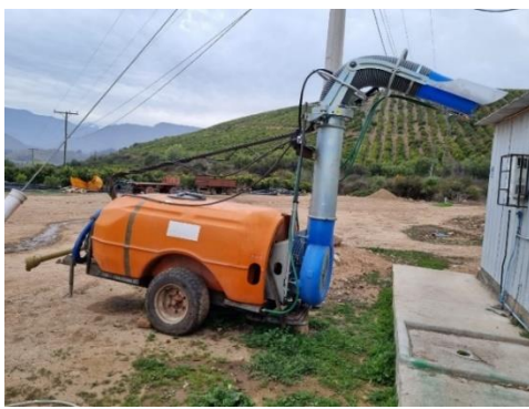
Figura 2-16. Registro fotográfico pulverizadora.
