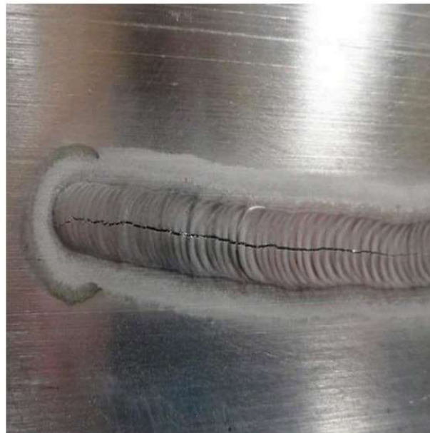
Ilustración 3- Soldadura Agrietamiento Fuente: Google imágenes
