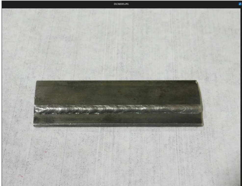
Ilustración 42- Prueba de campo nr.1 - Soldadura en buen estado Fuente: Elaboración propia
