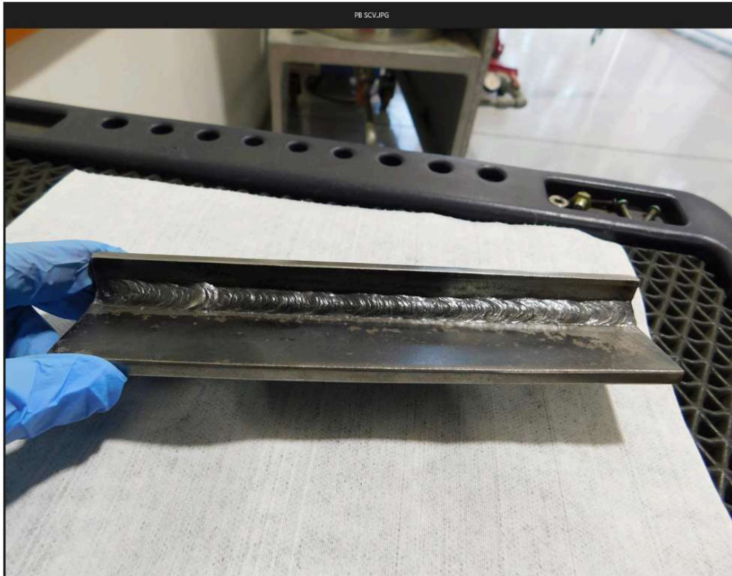
Ilustración 50- Prueba de campo Nr. 5 socavación Fuente: Elaboración propia
