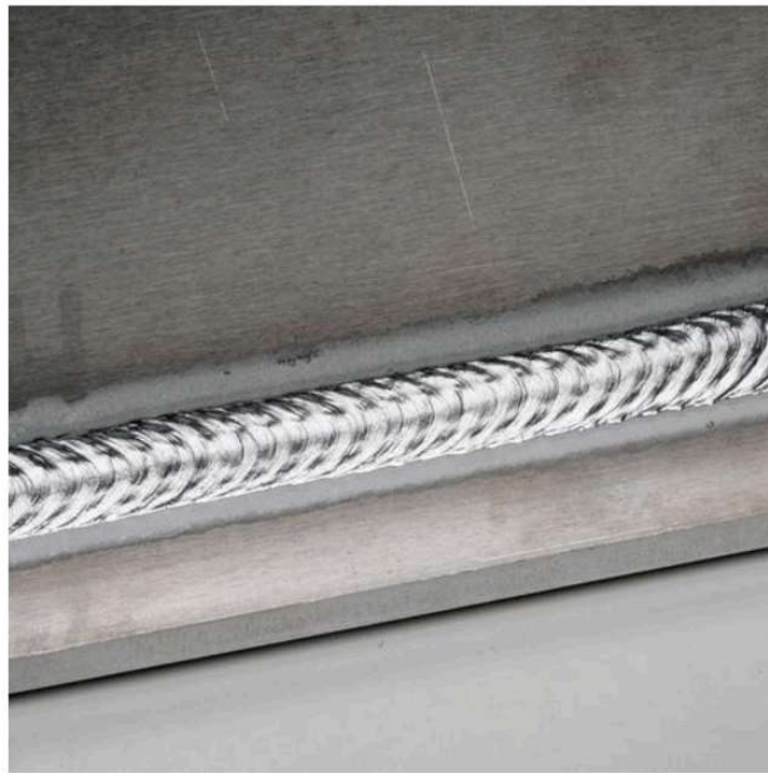
Ilustración 1- Soldadura en buen estado 1
