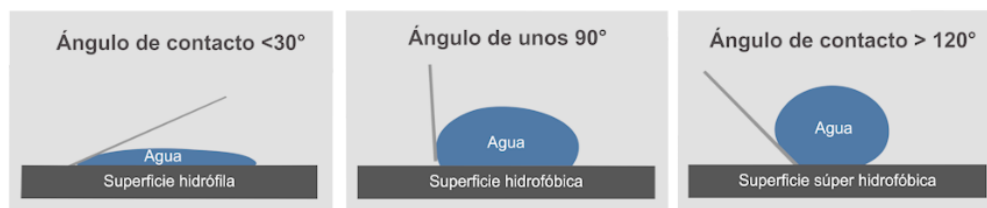
Figura 10. Significado ángulo de contacto, según tipo de superficie. Fuente: Cenano Latinoamérica.
