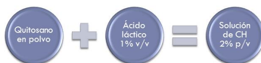
Figura 13. Preparación de la solución de quitosano al 2% p/v. Fuente: Elaboración propia.
