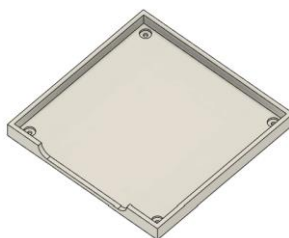
Figura 4.8: Base de actuadores vista general
