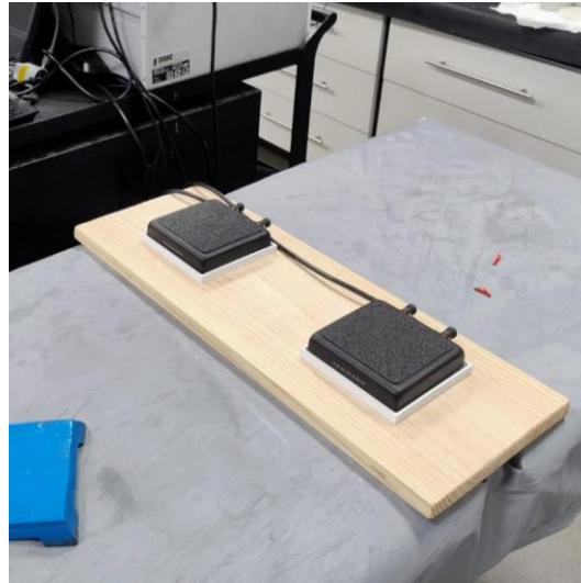
Figura 6.3: Actuadores posicionados y conectados en placa inferior.
