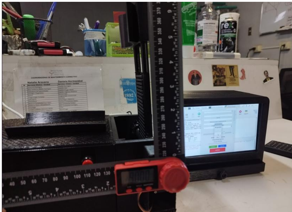
Figura 3-9. Calibración con goniómetro en 90°.
