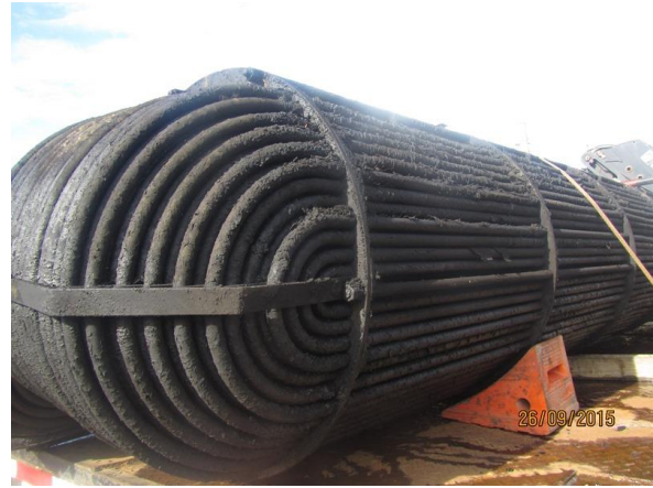
Figura IV.24: Ensuciamiento de tubos por el lado de la carcasa.
