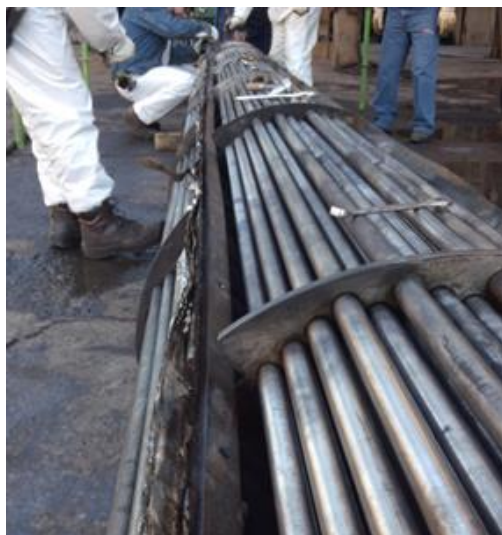
Figura XI.7: Vista superior de lina de sello longitudinal para intercambiador tipo F. Fuente: Departamento de mantención, Enap Bío-Bío
