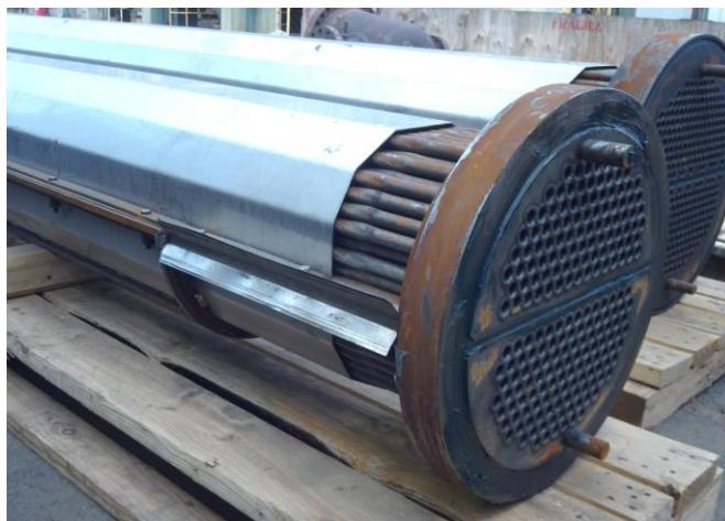
Figura XI.9: Lainas de haz tubular trenzado tipo F. Fuente: Departamento de mantención, Enap Bío-Bío
