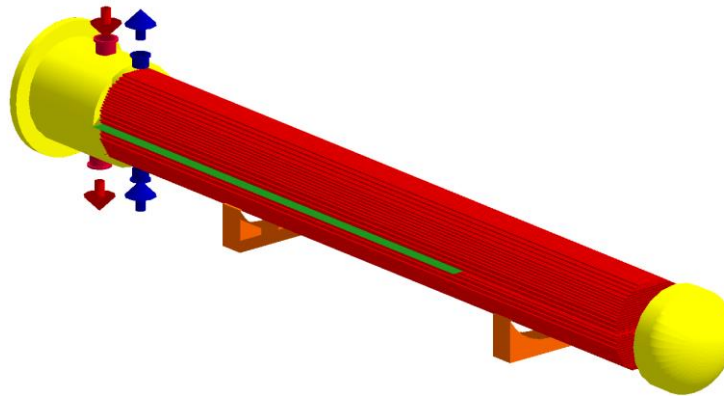
Figura V.9: Esquema del rediseño para intercambiadores de tubo y carcasa con tubos twisted .
