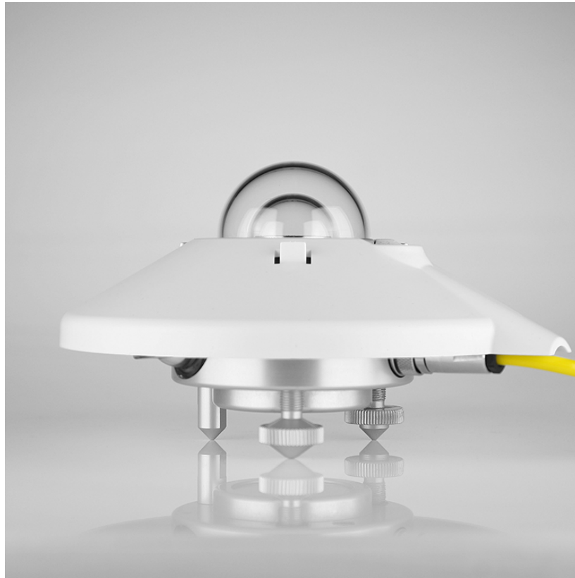
Fig. 3.2: Piranómetro Kipp & Zonen CMP11
