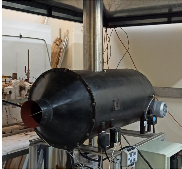
Imagen 2.5 Fotografía real del diseño del generador de aire caliente.
