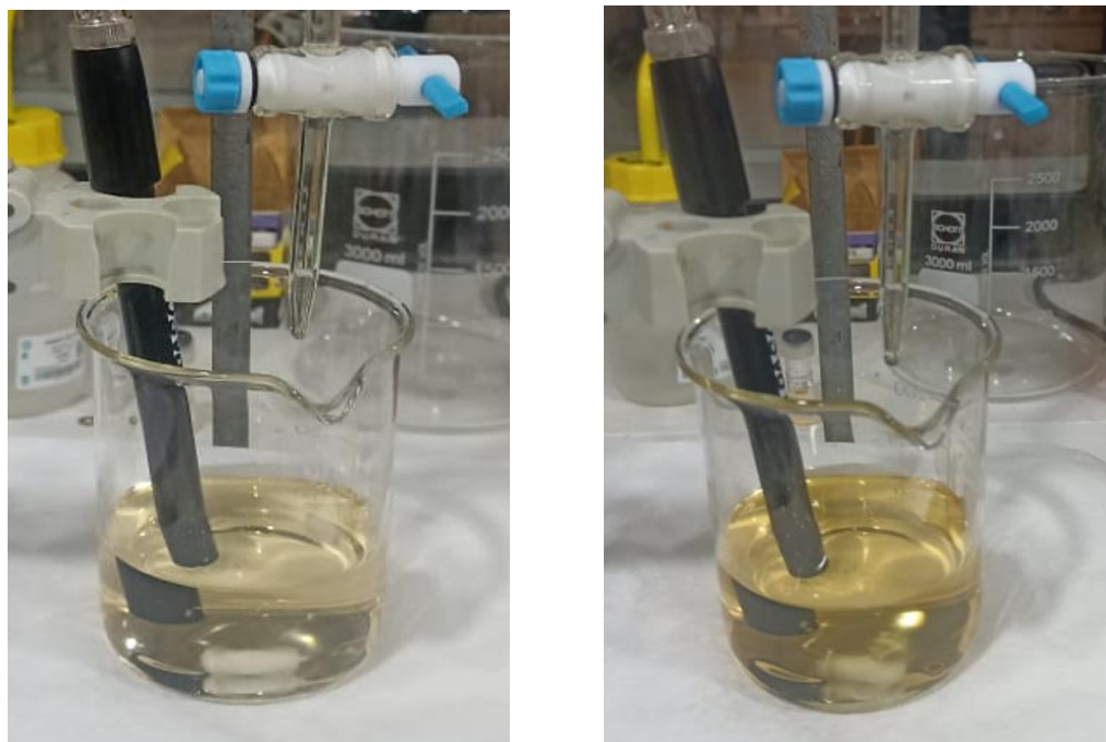
Figura 26: A la izquierda, titulación ácida en solución D hasta pH 2,5. A la derecha, continuación de la titulación ácida en solución D hasta pH 3,2.
