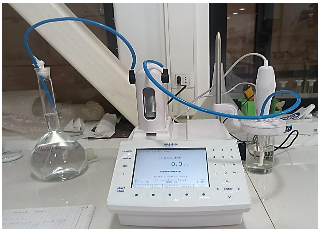
Figura 15: Montaje de titulación con equipo Hanna HI931.
