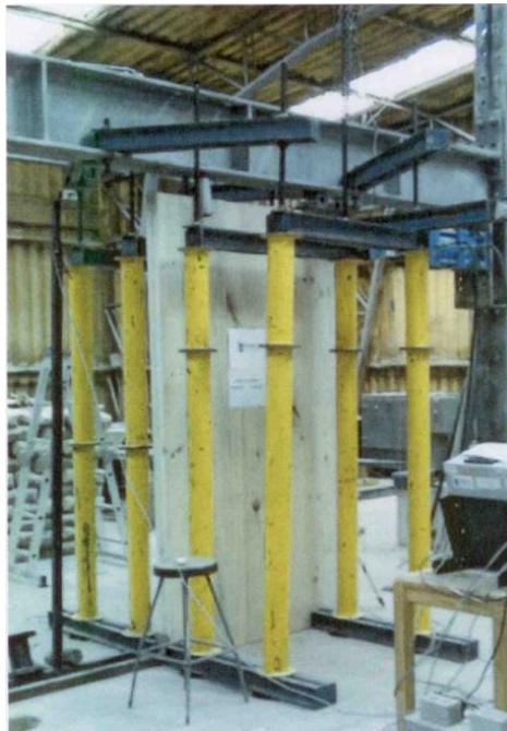
Figura n°7: Implementación del ensayo de carga horizontal.
