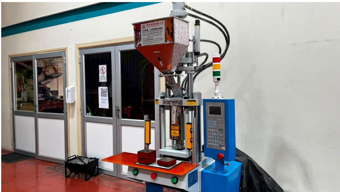
Figura 1-1. Inyectora vertical JIEYANG disponible para el proyecto.
