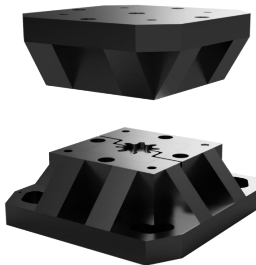
Figura 3-3. Vista general del conjunto de moldeo.
