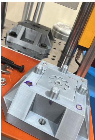
Figura 3-6. Cavidad y elementos de alineación del prototipo físico.
