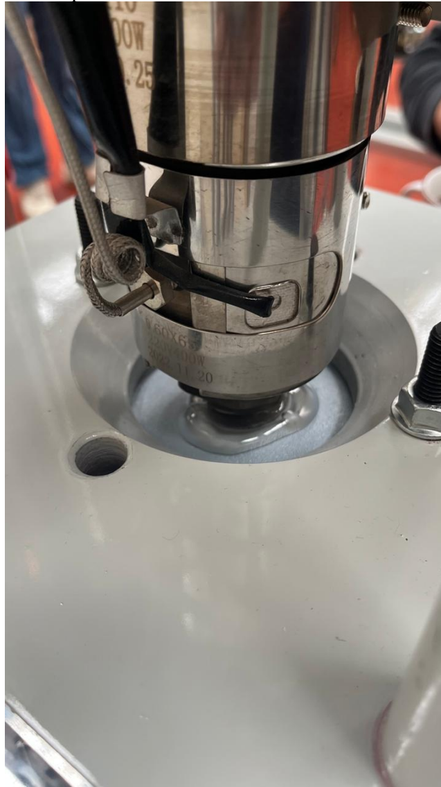
Figura D-6. Contacto de la boquilla con la entrada del molde de PLA.
