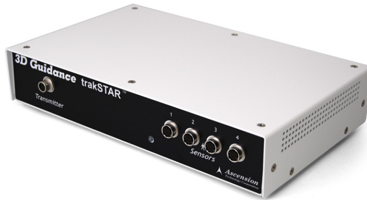
Figura 3.1: Dispositivo controlador del magnetómetro trakSTAR™.
