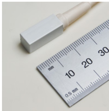
Figura 3.2: Sensor ( probe ) del magnetómetro trakSTAR™.
