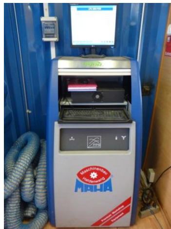
Ilustración 2.4 Rack que contiene computador de control del dinamómetro. (Fuente propia)
