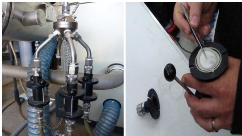
Ilustración 2.7 Los porta-filtros en la figura izquierda y el porta-filtro abierto junto con la manipulación de este en la foto derecha.
