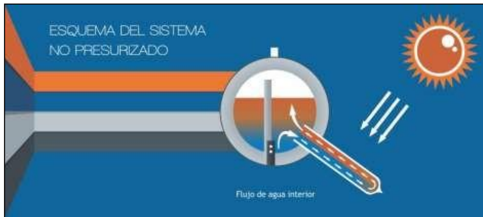
Figura 3: Esquema del sistema no presurizado.
