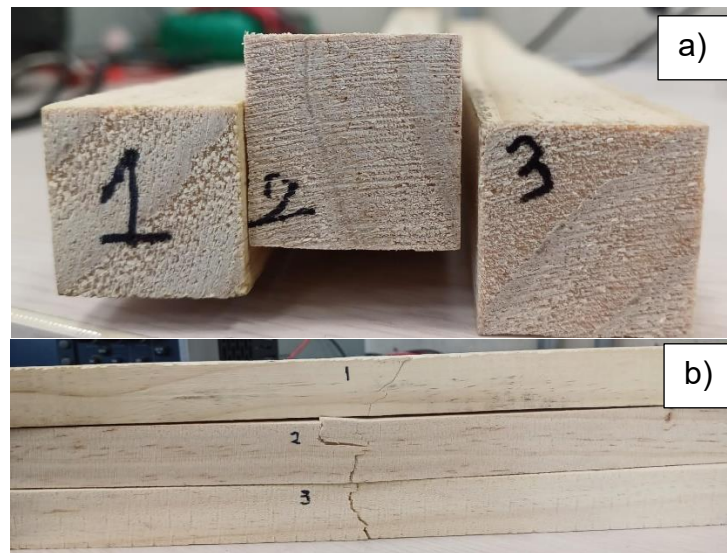
Figura 45 Maderas flexión sin reforzar. a) vista transversal, b) vista inferior al punzón.
