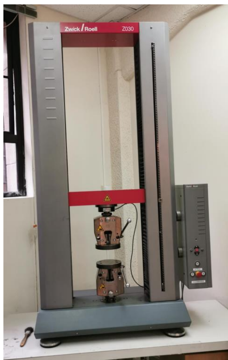
Figura 26 Equipo de Ensayos Universales Zwick/Roell Z030 configurado para compresión
